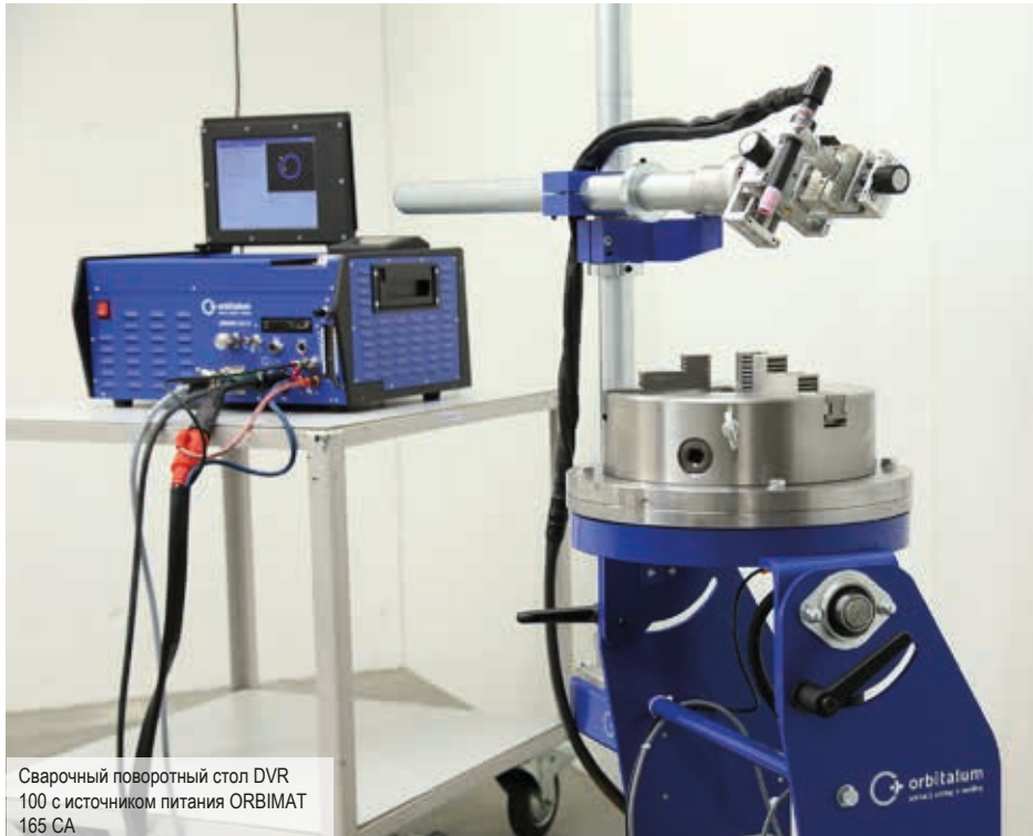
Трехкулачковый патрон для точного позиционирования и фиксации заготовки
