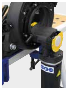
Включая второе положение пильного диска для обрезки трубных отводов
