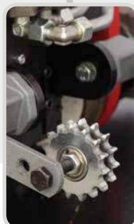
Сочетание двух боковых цепей и центрального направляющего ремня обеспечивает высокую точность и высококачественную отделку на всех этапах работы. Простая и быстрая настройка и оригинальный дизайн являются дополнительным преимуществом этой модели. Система тяги использует резиновые колеса с высоким сцеплением, которые позволяют агрегату работать в любом положении.
